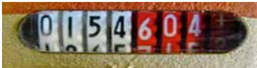
Figuur 2: Bij deze watermeter is de stand 154,604 m 3 .
