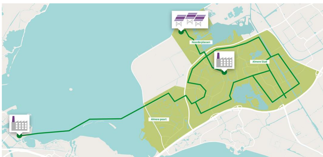
Figuur 3.9 Het warmtenet in Almere. Het gearceerde deel geeft het leveringsgebied van Vattenfall weer.
