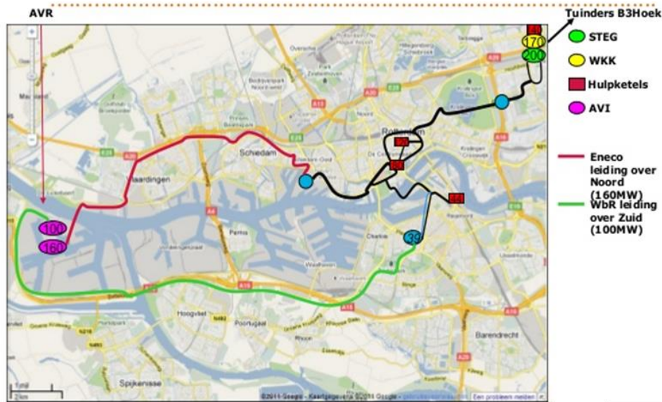
Figuur 5: Warmtenetwerk Rotterdam (Eneco, 2012)*
